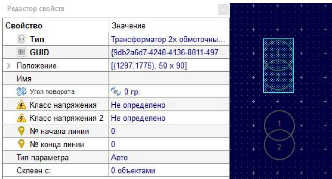
Рисунок 4.80 – Объект типа «Трансформатор 2х обмоточный»
