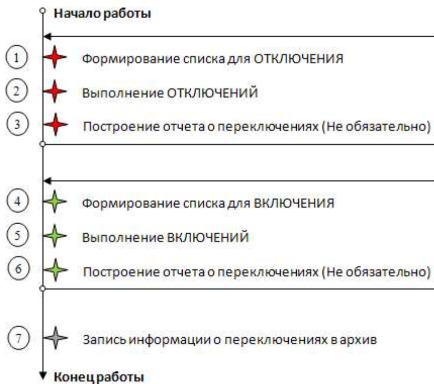
Рисунок 2.2 – Схема выполнения переключений
